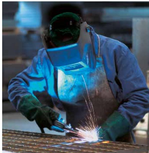
I pannelli tagliati a misura vengono finiti con l'applicazione della bordatura, che consiste nella saldatura di un piatto avente la stessa altezza dei piatti portanti che compongono il grigliato. Gridiron è specializzata nel taglio e nella sagomatura a disegno dei pannelli di grigliato.
