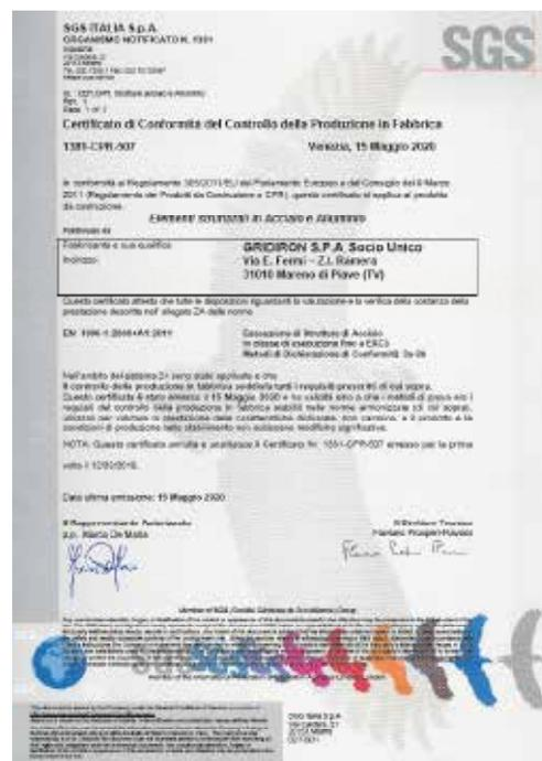
La norma UNI EN 1090- richiede al produttore la dimostrazione ad un ente di parte terza di **possedere tutti i requisiti necessari alla marcatura CE**, tra questi hanno particolare importanza i **processi di saldatura** e gli addetti a svolgere tale mansioni.
