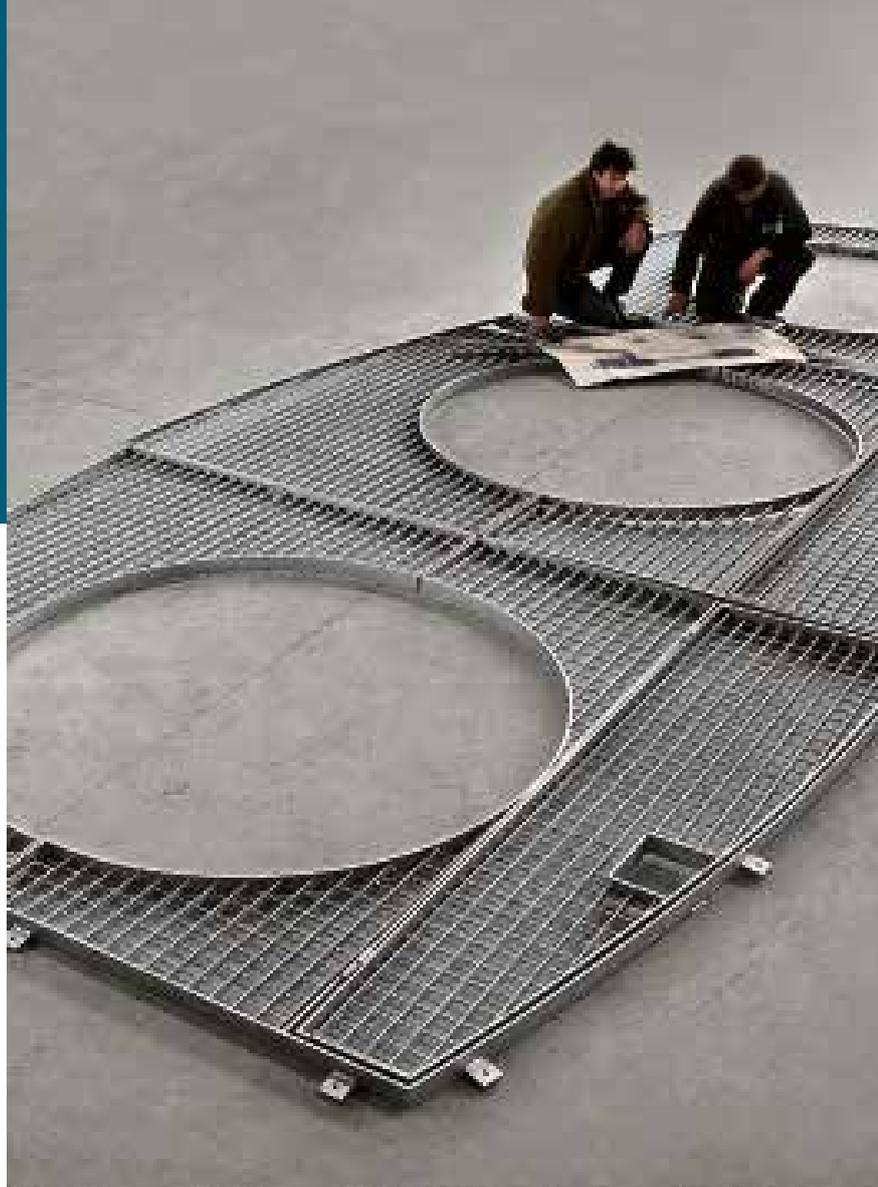
La notevole versatilità del grigliato elettrosaldato e pressato permette la realizzazione di particolari tagli lineari, trasversali o curvilinei sui pannelli che così sagomati rispondono pienamente a qualsiasi richiesta speciale.
