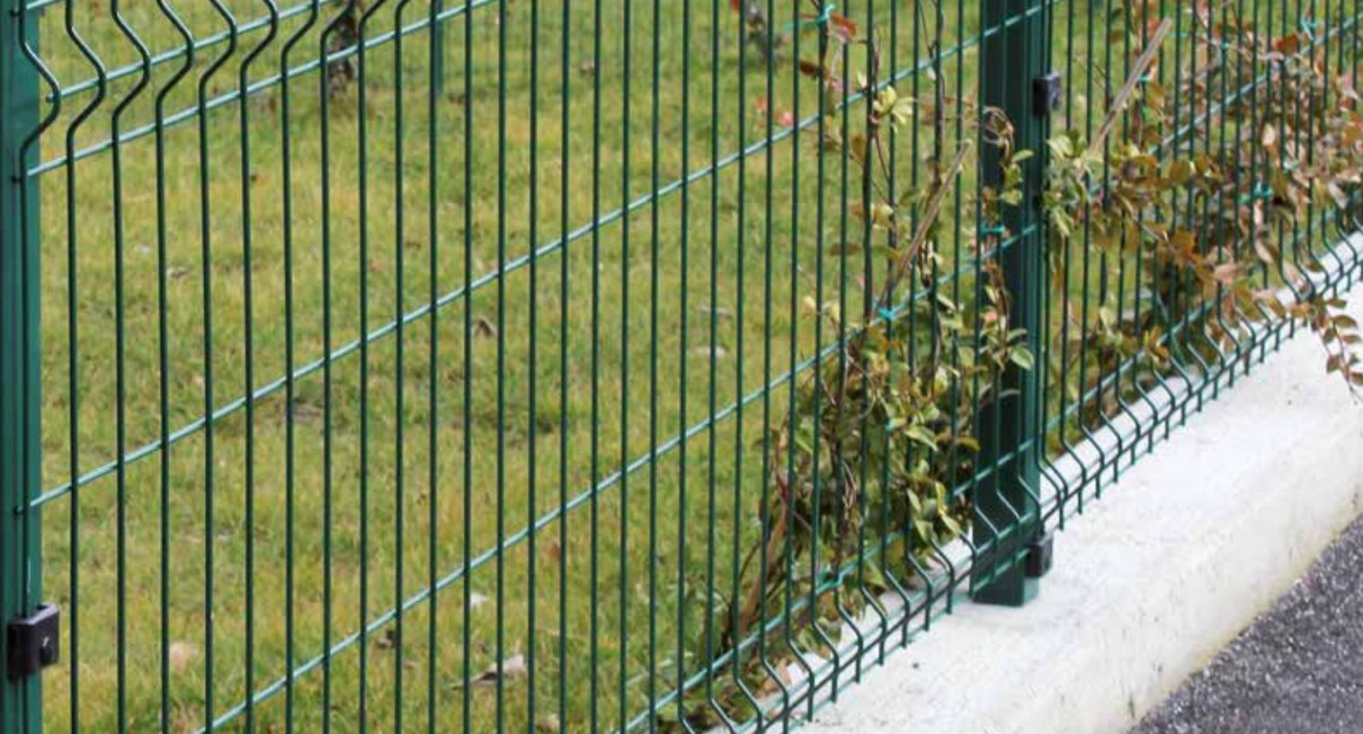
Le piantane **Easy** a cementare sono realizzate in tubolare 50x50 mm con spessore 2 mm preforato dove all'interno vengono applicati inserti zincati filettati antistrappo e predisposte per essere murate di 300 mm nella parte inferiore indicata dalla presenza di un foro passante. Il foro passante viene infatti utilizzato per l'allineamento a terra della piantana attraverso l'uso di uno spinotto.
