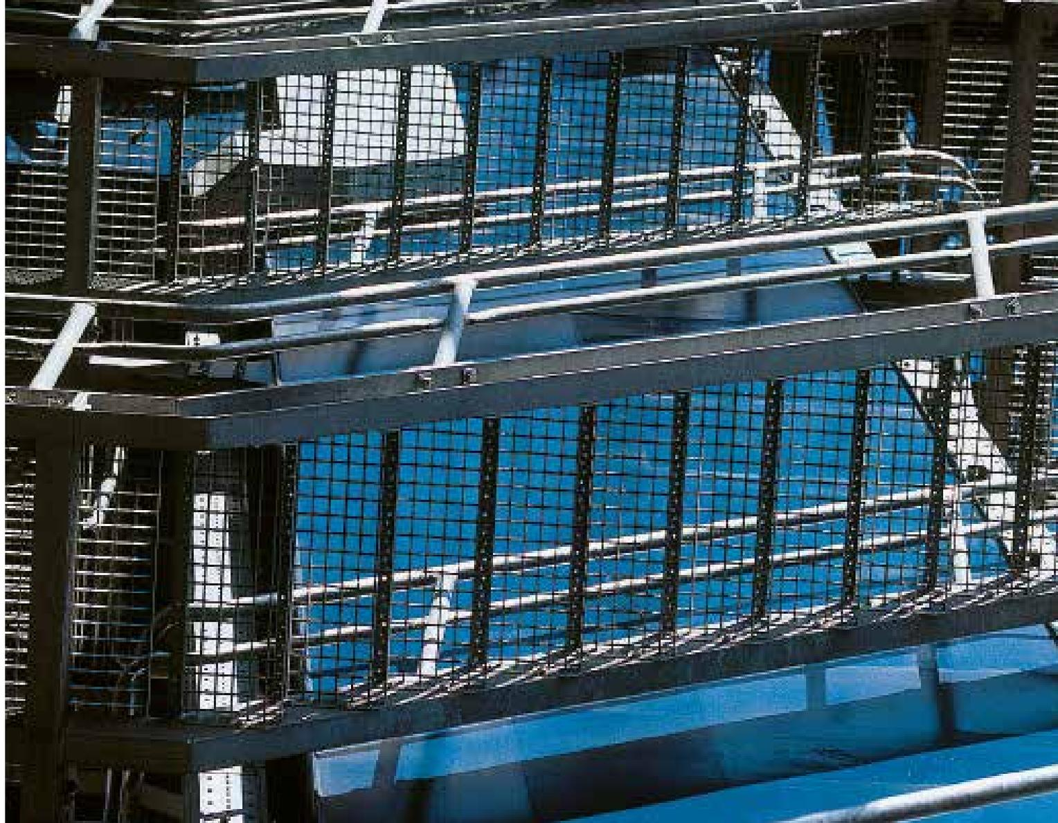
La linea standard dei gradini in grigliato elettrosaldato viene proposta in tre tipi di maglie. La quadrata 34×38 per le applicazioni industriali, la classica 25×76 e l'antitacco 15×76 particolarmente idonea per le scale di sicurezza. I gradini possono essere costruiti a misura secondo le specifiche del cliente.
