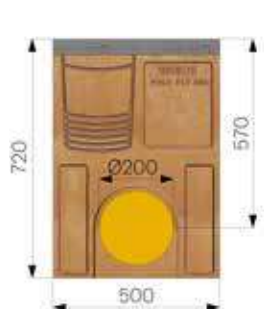
Pozzetto in cemento polimerico con profili zincati
